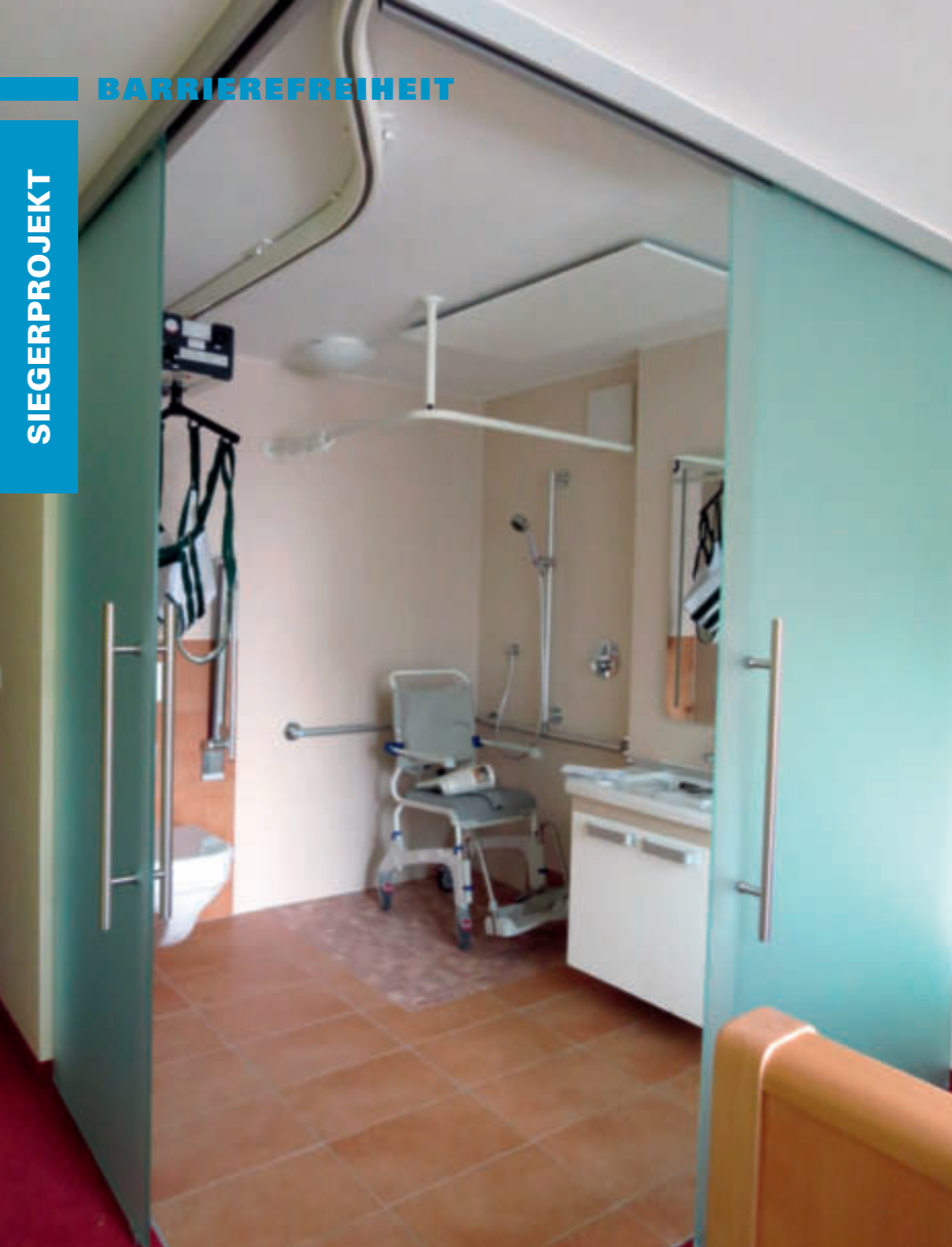
Aus einem 3-Bett-Pensionszimmer (Bild oben) wurde ein durchdachter, barrierefreier Wohn-, Schlaf- und Baderaum. Die Deckenschiene vom Bett (Bild ganz oben) in den Sanitärbereich (li.) erleichtern den Alltag enorm.
